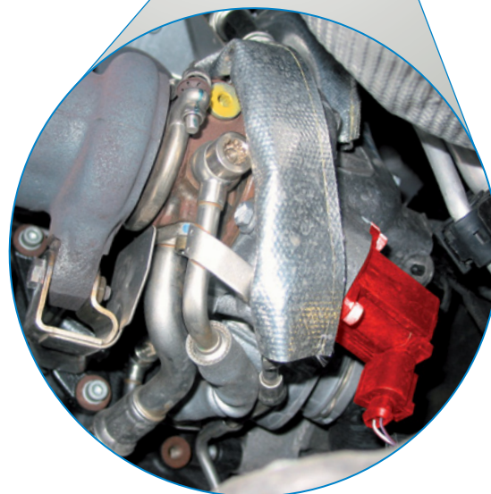
Valve de dérivation sur la VW EOS TFSI (en rouge)
